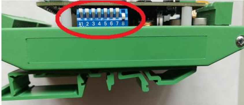
Fig.: Modbus parameters configuration
